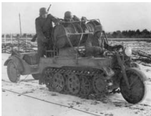
Немецкая машина для прокладки линии связи
