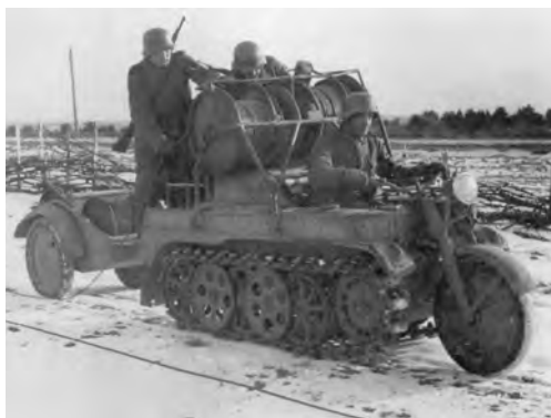
Немецкая машина для прокладки линии связи
